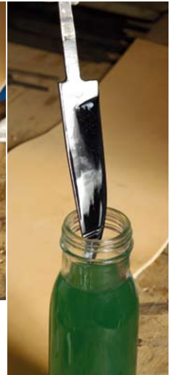
6 Tauchbad: Wir halten die Klinge für wenige Minuten in die Brünierlösung. Sie nimmt rasch eine dunkle Farbe an.
