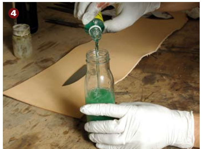
4 Vorbereitung: Wir füllen die Schnellbrünierung in ein schlanke Glasgefäß um, damit wir die Klinge eintauchen können.
