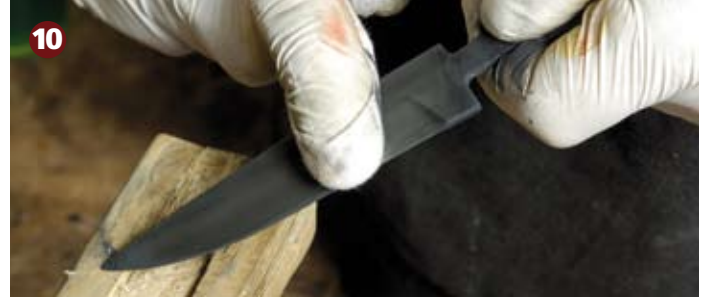
10 Abreiben: Die getrocknete Oberfläche wird mit einem Lappen kräftig abgerubbelt. Dadurch wird sie wesentlich glatter und dunkler.
