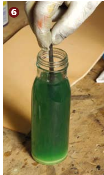
6 Tauchbad: Wir halten die Klinge für wenige Minuten in die Brünierlösung. Sie nimmt rasch eine dunkle Farbe an.
