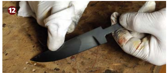
12 Ölen: Das abschließende Einölen (hier mit Ballistol) sorgt für einen dunkleren Glanz und vor allem für einen guten Rostschutz.
