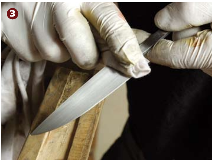
3 Entfetten: Vor dem Brünieren muss die Oberfläche mit Aceton oder einem Entfetter absolut fettfrei gemacht werden.
