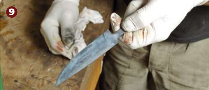
9 Nach dem Trocknen: Die Oberfläche sieht zunächst sehr rau, grau und unschön aus, aber das ändert sich gleich.
