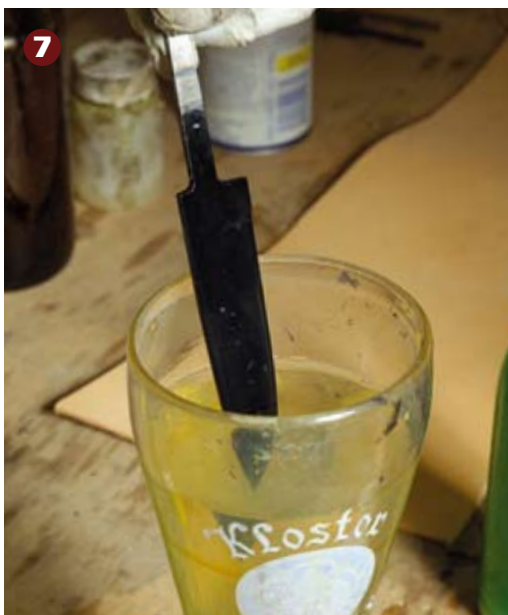
7 Spülen: Die Klinge wird dann sofort in klarem Wasser gründlich abgespült.
