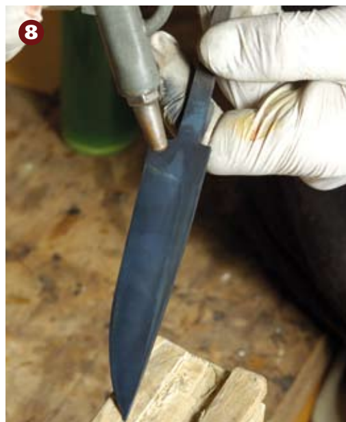
8 Lufttrocknen: Wir blasen die Klinge mit Druckluft ab, man kann sie aber auch „trockenwedeln“.
