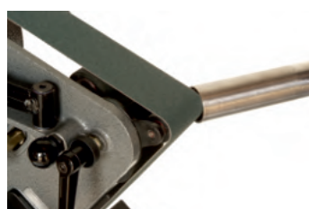
Anfasen und Verschleifen von Rohren auf Innen- und Aussenseite
