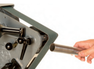
Anfasen und Verschleifen von Rohren auf Innen- und Aussenseite
