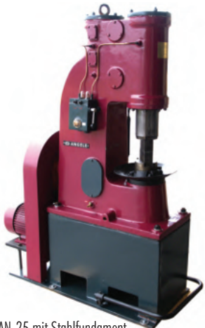
AN-25 mit Stahlfundament
